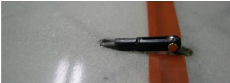
Aspecto final de la transmisión del servo al flaperón
